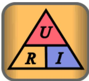
Die Spannung (U) ist das Produkt aus dem Widerstand (R) mal die Stromstärke (I).
